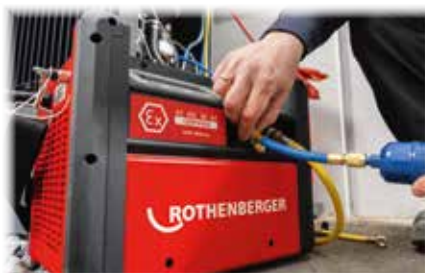
Filter za bezbedno izvlačenje freona uključen u obim isporuke
